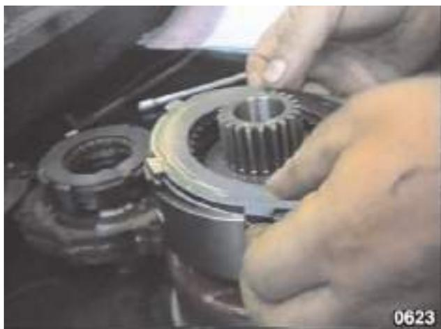
Fig. 47 - Déposer la rondelle d'appui de l'embrayage "HIGH".
