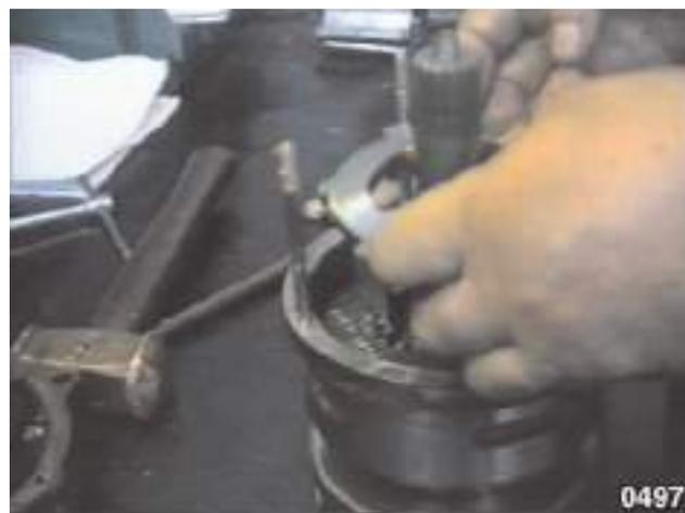
Fig. 38 - Déposer les disques de l'embrayage "MEDIUM".
