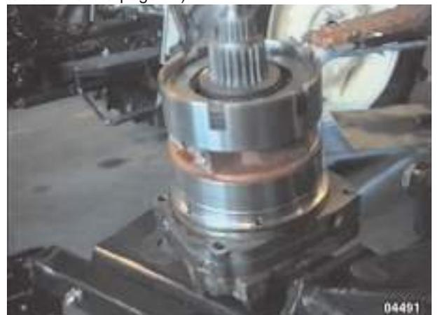
Fig. 59 - Le positionnement de l'ensemble Powershift dans le carter de boîte passe par le réglage du jeu axial de l'arbre en prise avec le réducteur épicycloïdal.
