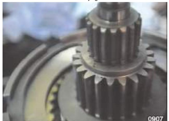
Fig. 77 - Monter la bague de l'embrayage "MEDIUM" avec les dégagements orientés vers le circlip.
