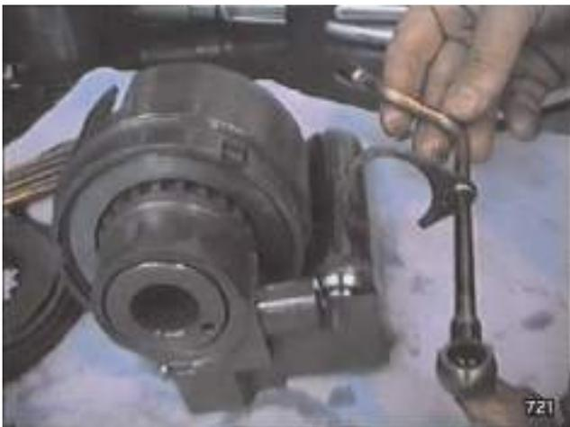
Fig. 33 - Débrancher complètement le tube de lubrification.
