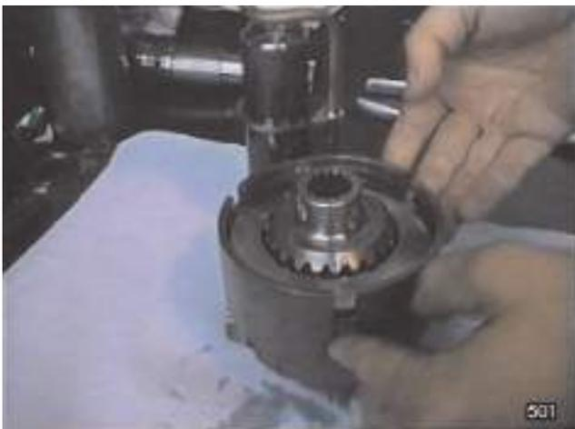
Fig. 23 - Déposer les disques de l'embrayage.
