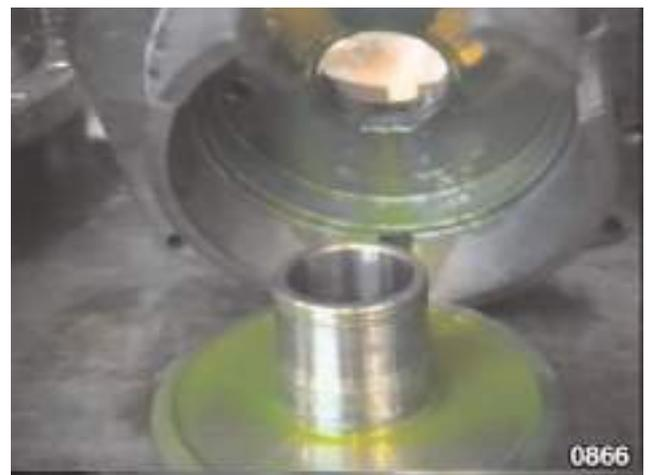
Fig. 64 - Déposer le piston.
