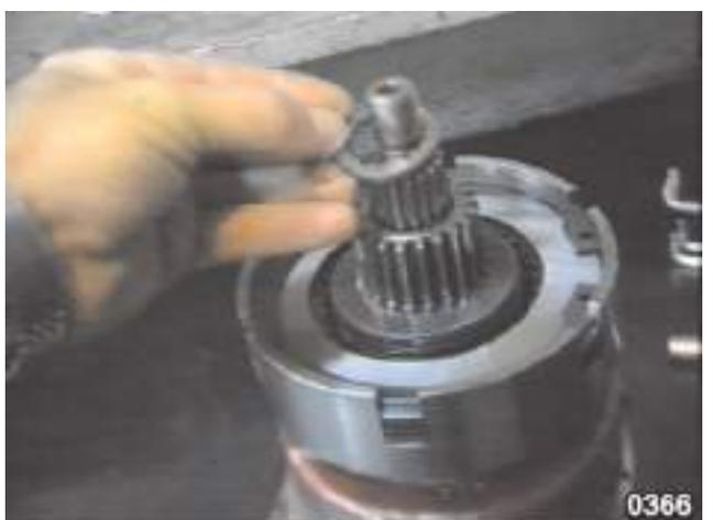
Fig. 24 - Déposer la rondelle d'appui.
