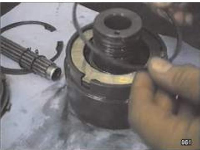
Fig. 41 - Déposer le circlip de retenue de la rondelle d'appui du disque de frein.
